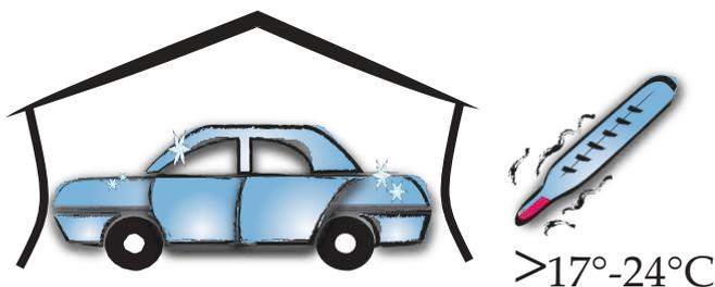
Die ideale Umgebung für eine Fahrzeugvollverklebung ist eine gut beleuchtete, staubfreie Umgebung mit einer Temperatur zwischen 17°C und 24°C. Auch die Folie soll genügend akklimatisieren. Bei dieser Arbeit raten wir Ihnen, alle störende Bauteile, wie z.B. Nummernschilder, Fenstergummis, Spiegel, Antennen, usw... zu entfernen um die Montage der Folie zu erleichtern.
