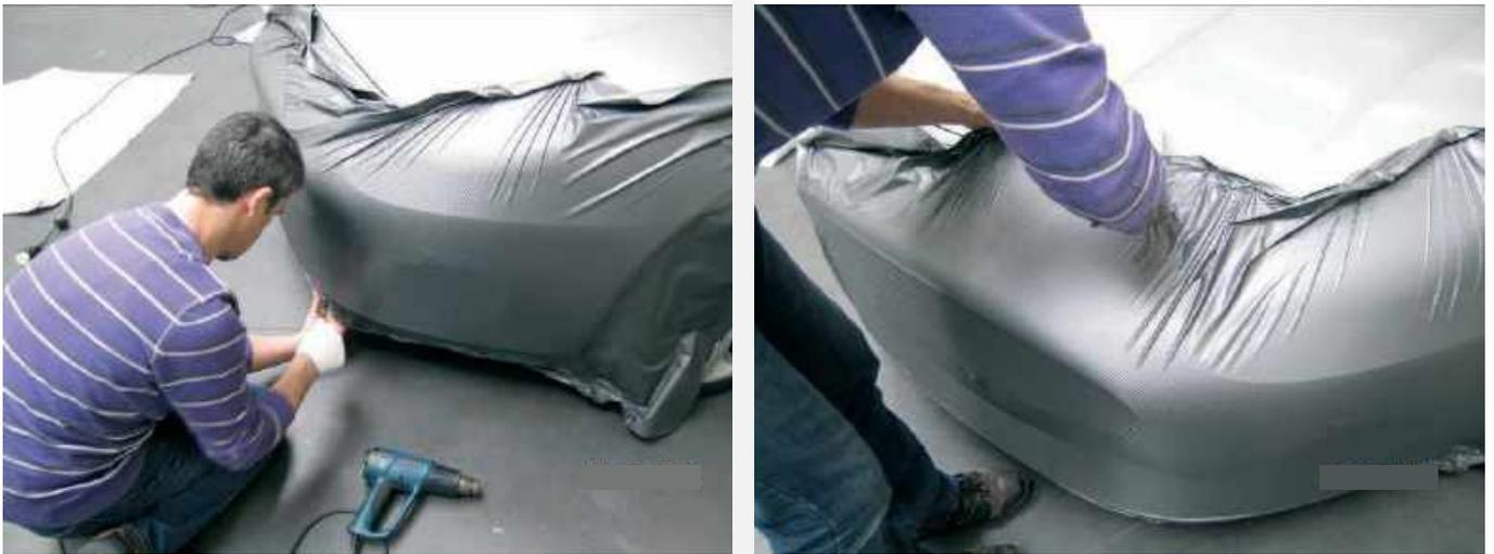
Die obere und untere Seite der Stoßstange wird gleich verklebt
