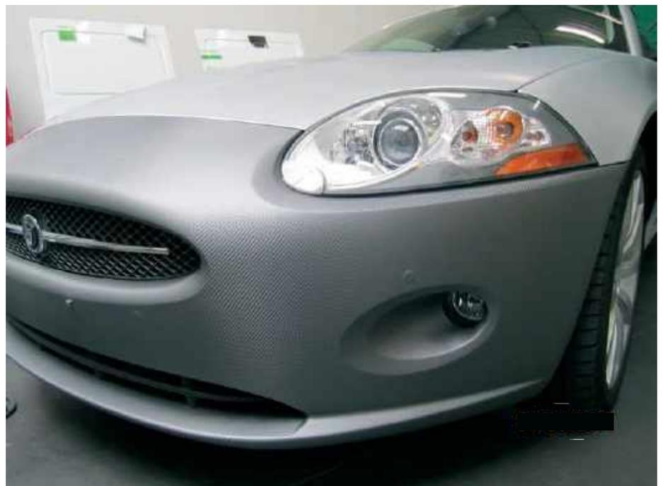
*Vorderseite eines Jaguar XK, wobei die Vertiefungen problemlos mit einer Carbon Folie mitverklebt werden*
