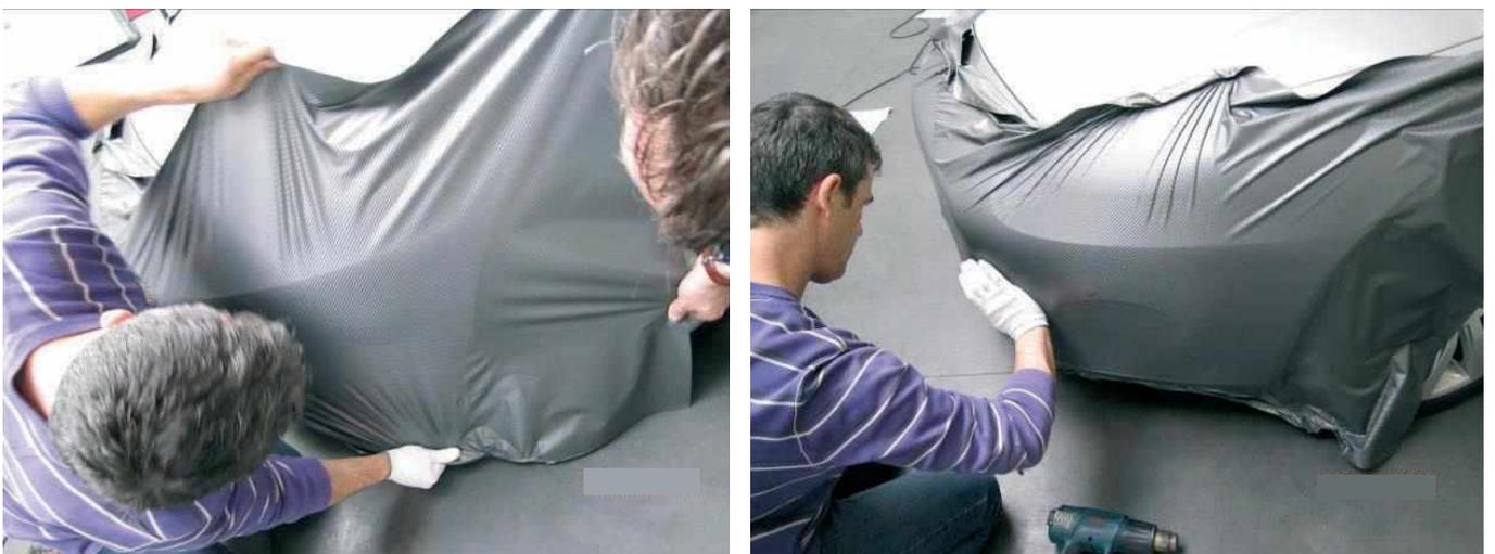
Spannen Sie die Folie um die Stoßstange und drücken Sie sie leicht an.
