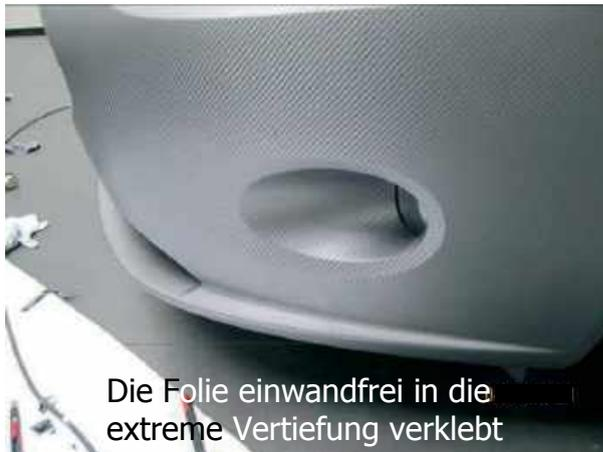
Damit eine gute Haftung garantiert werden kann, raten wir Ihnen die verklebte Folie immer noch mal nachzuheizen (Temperatur Gebläse 350°C – dies stimmt mit etwa 90°C auf der Folie überein). Wenn die Folie abgekühlt ist, die Verklebung noch mal fest andrücken (vor allem in den Vertiefungen). Achten Sie darauf, daß die Folie ÜBERALL fest angedrückt ist bevor Sie sie nachheizen, sonst wird die Folie aufplatzen, dort wo sie nicht genügend angedrückt wurde (sehen Sie das Bild 51) !
