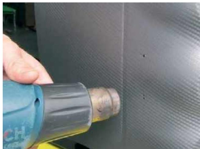
**Drücken Sie die Folie fest an bevor Sie sie nachheizen. Verwenden Sie einen Raker in den Ecken. Wenn die Folie nicht gut angedrückt ist, wird sie beim Heizen möglich aufplatzen.**
