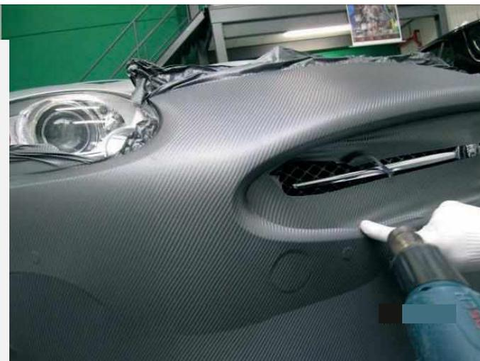
Heizen Sie die Folie über dem Kühlgitter (immer an der anderen Seite als dort, wo Sie die Folie verkleben werden), und verkleben Sie die Folie schrittweise
