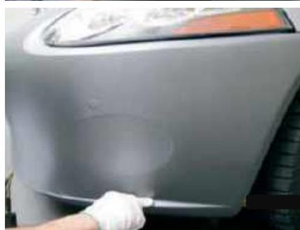
Heizen Sie die Folie ein wenig an den Rändern und verkleben Sie sie einige mm um den Rand (um den Rand zu "brechen"). Heizen Sie dann die Folie an der "gegenüberliegenden" Seite und drücken Sie sie schrittweise in die Vertiefung.
