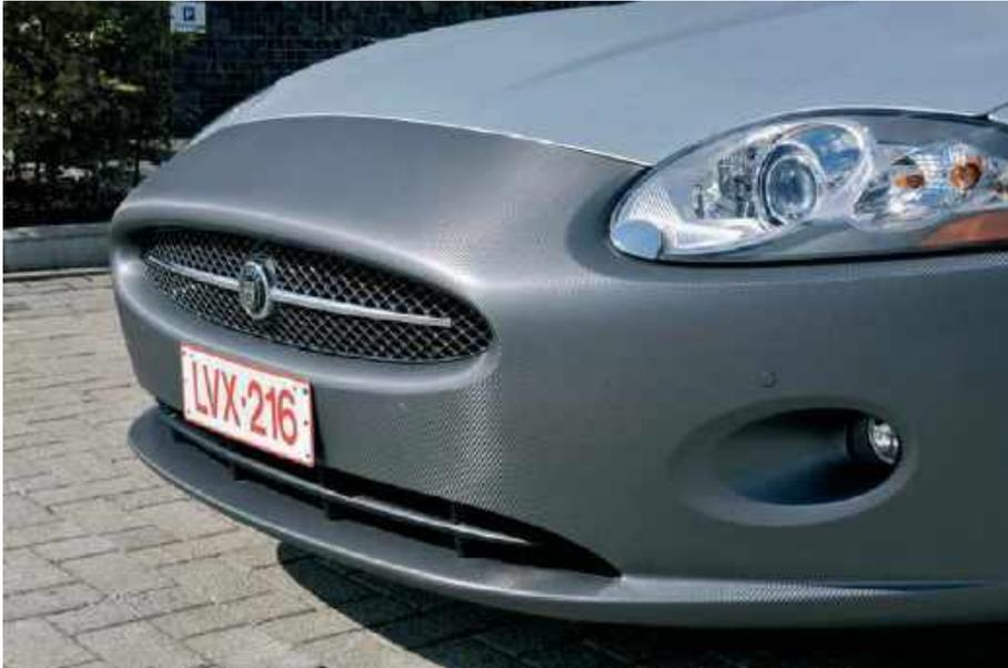
In diesem Beispiel zeigen wir Ihnen, wie eine strukturierte Graficast Carbon Folie auf die Stoßstange eines Jaguar XK verklebt wird. Wie Sie sehen können, wird diese Stoßstange von einer sehr starken Rundung und einigen extremen Vertiefungen gekennzeichnet.
