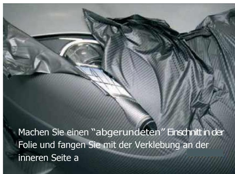
Machen Sie einen "abgerundeten" Einschnitt in der Folie und fangen Sie mit der Verklebung an der inneren Seite an
